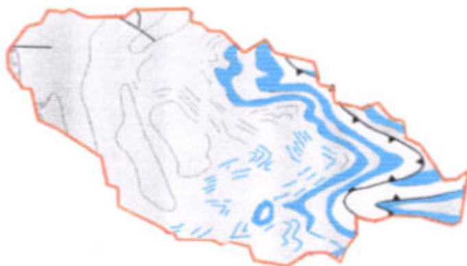
Figura V.2.5.42 Unidad hidrogeológica de la Caliza de Montaña, caracterizada por presentar un modelo de circulación cárstica.
